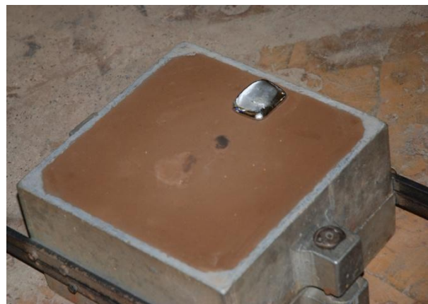
Figure 17 : Coulée et remplissage du moule
