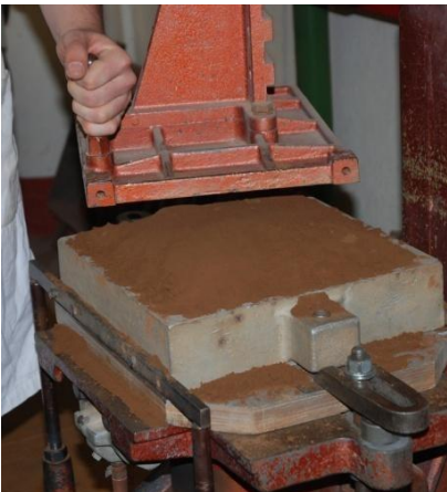
Figure 7 : Tassement mécanique du sable à vert dans le châssis
