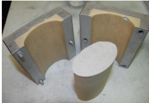
Figure 3 : Le noyau sorti de sa boîte
