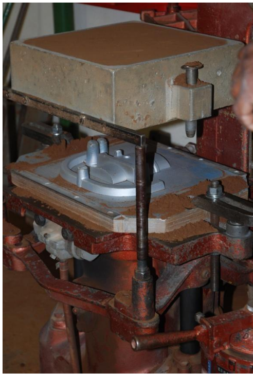
Figure 9 : Montée du châssis, libération des plaques modèle
