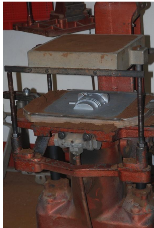
Figure 9 : Montée du châssis, libération des plaques modèle
