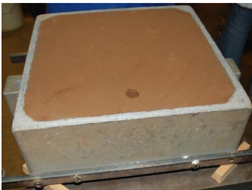
Figure 13 : Finition du trou de coulée
