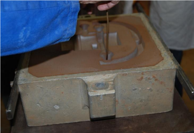
Figure 11 : Réalisation des évents à l'aiguille
