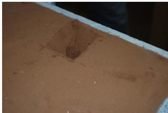
Figure 13 : Finition du trou de coulée
