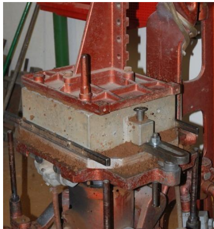
Figure 7 : Tassement mécanique du sable à vert dans le châssis
