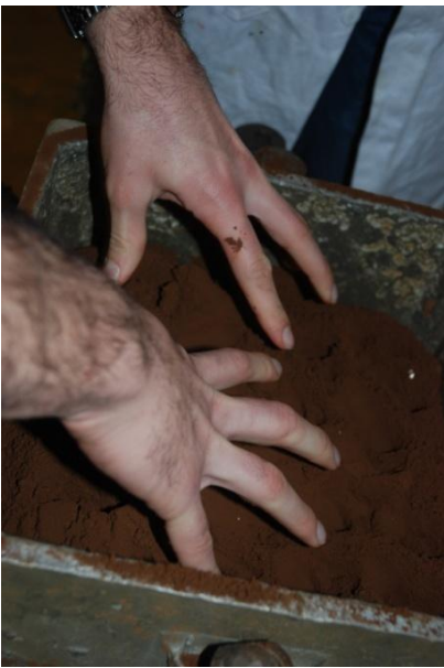
terminant le travail (figure 7). Figure 6 : Remplissage du châssis avec le sable à vert
