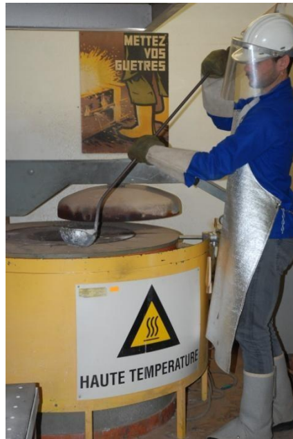
Figure 16 : Prélèvement de l'alliage liquide
