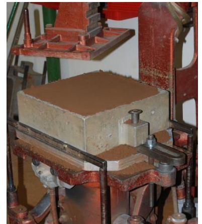
terminant le travail (figure 7). Figure 6 : Remplissage du châssis avec le sable à vert
