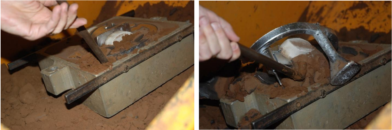
Figure 20 : Destruction du moule pour extraire la pièce brute de moulage et son noyau inclus
