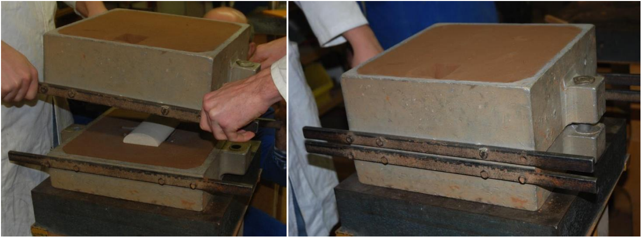
Figure 15 : Assemblage des deux châssis
