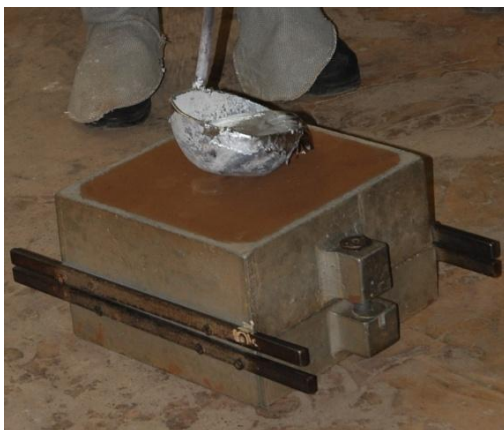
Figure 17 : Coulée et remplissage du moule
