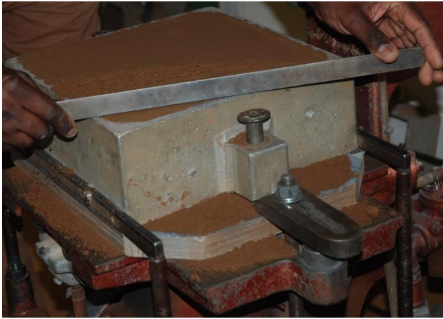
Figure 8 : Arasement du sable (raclage)
