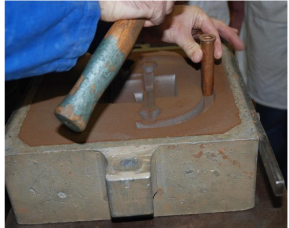
Figure 12 : Prolongation du trou de coulée
