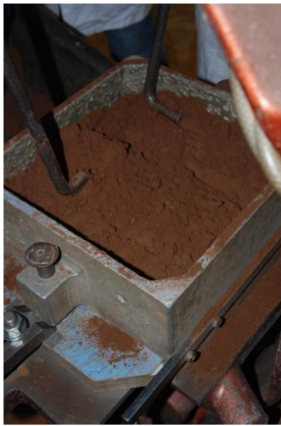
terminant le travail (figure 7). Figure 6 : Remplissage du châssis avec le sable à vert
