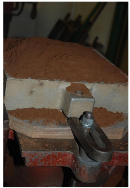
terminant le travail (figure 7). Figure 6 : Remplissage du châssis avec le sable à vert
