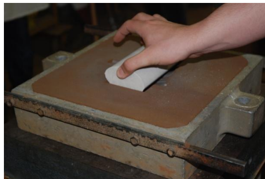
Figure 14 : Positionnement du noyau
