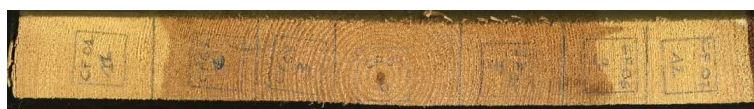
FIGURE 2.2 – Exemple de tracé d'éprouvettes barreaux sur la section transversale d'une planche de 50 cm de long de pin à crochets
