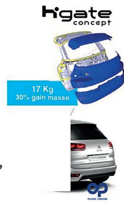
Photo 4 – La technologie Higate associant thermodurcissables et thermoplastiques
