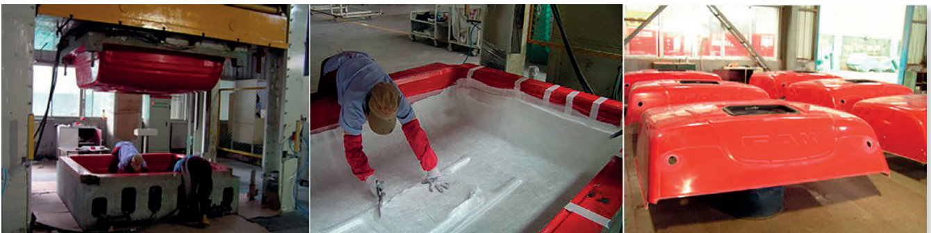
Photo 34 – Fabrication de pavillon de camion en compression BP à froid
