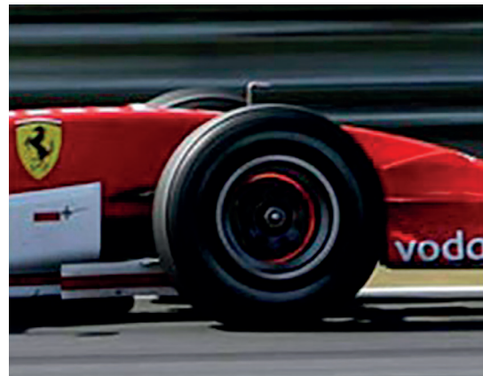
Photo 12 - Les disques de frein carbone permettent aux Ferrari de faire face à des décélérations pouvant atteindre 5G depuis des vitesses de l'ordre de 340 km/h
