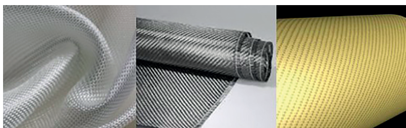
Photo 23 – Tissus de verre, carbone et aramide
