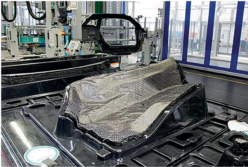
Photo 25 – Drapage d'un module de la BMWi3 dans le moule RTM haute pression
