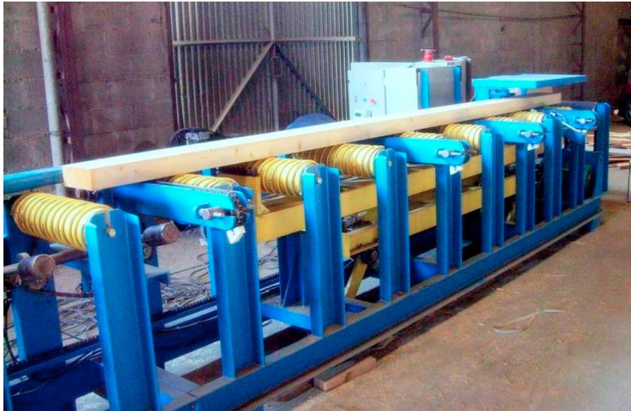
FIGURE 11 – Machine de classement automatique Noesys des bois par flexion 3 points continue (photo : Sébastien Paradis).
