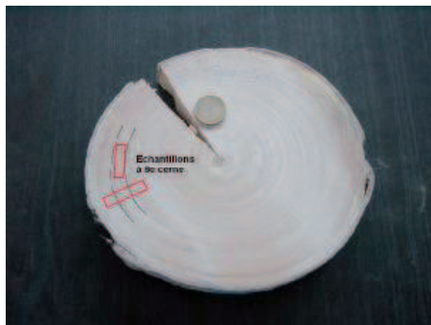
Figure 2.31 : Rondelle du peuplier utilisée pour les essais de compression sous microscope électronique à balayage.
