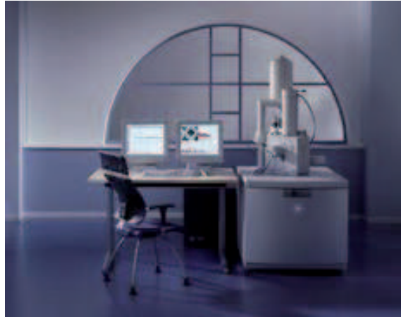
Figure 2.18 : Microscope électronique à balayage environnemental de la société FEI (Source site FEI)
