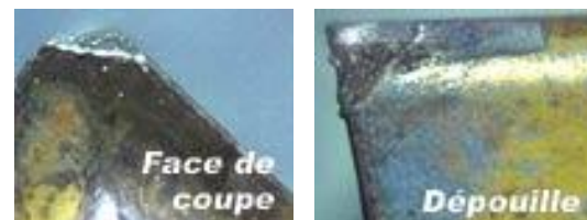
Ecaillage et fracturation
