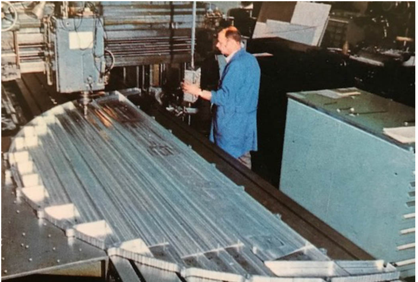
Cadre d'avion Mercure usiné dans la masse.
