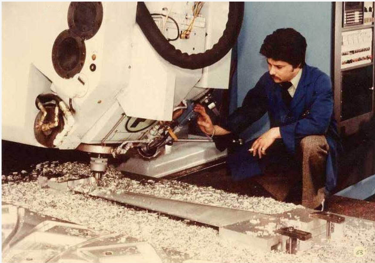
Usinage en commande numérique (CNC) de la maquette de soufflerie définie en CAO sous CATI. Dassault Aviation.
