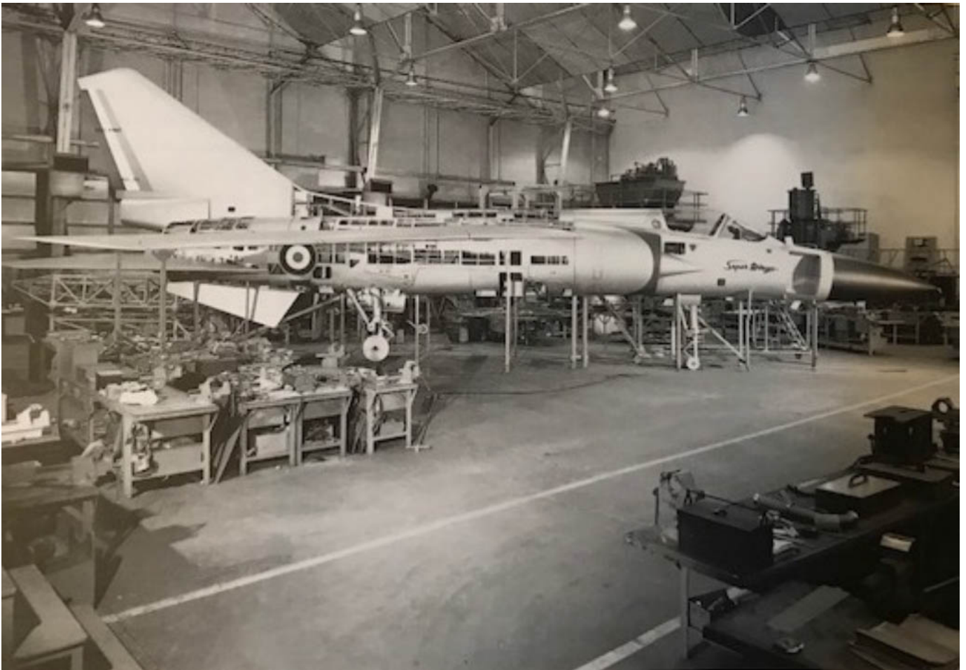
Maquette 3D échelle 1:1 d'un prototype d'avion en cours de conception dans les ateliers Dassault.
