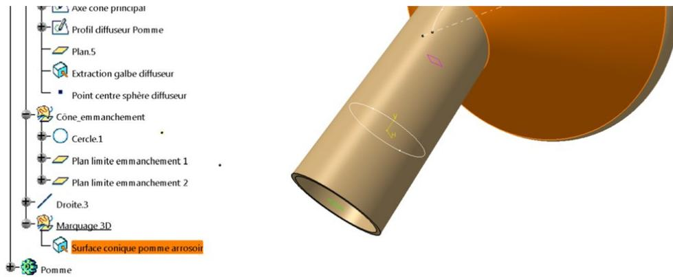
Cachons le reste et créons un plan passant par "axe cône principal" et la "droite.3".
