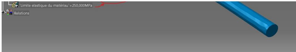
Le paramètre utilisateur de type “**proportion**” donne le **ratio** entre la **contrainte en compression dans la barre et la limite élastique du matériau**.
