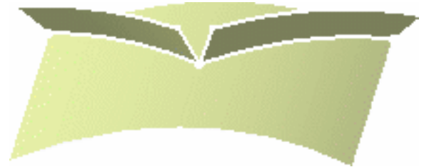
Spine discontinue en tangence avec des segments de balayage non connexes (le balayage n'est pas créé)
