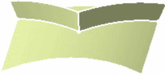
Spine discontinue en tangence avec des segments de balayage connexes (le balayage est créé)
