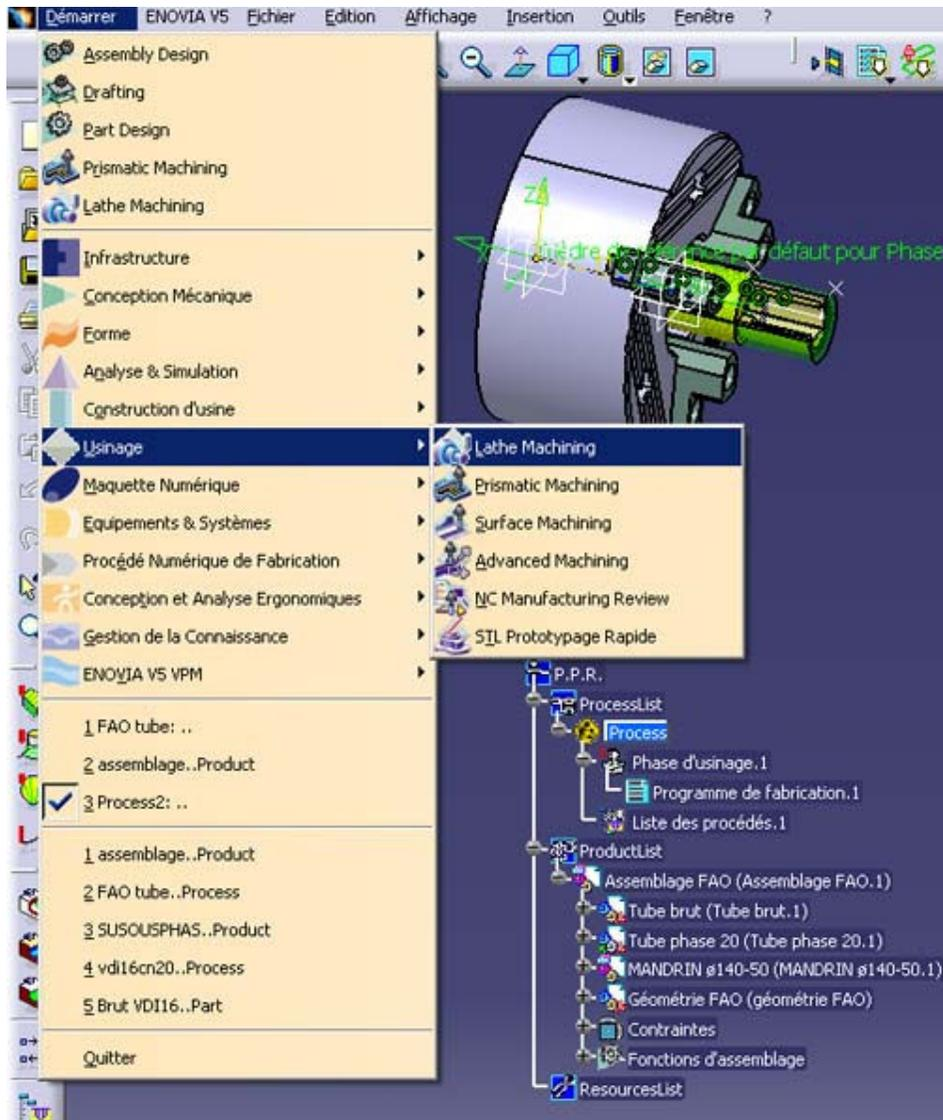
Ouvrir le fichier **assemblage ph20.CATProduct** et lancer l'atelier « Lathe Machining »
