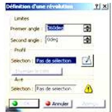
Rq : L'axe de la révolution peut être créé par l'icône
